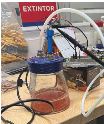
Figura 5. Montaje de la prueba sin burbujeo: la manguera de entrada no entra en contacto con la solución.
