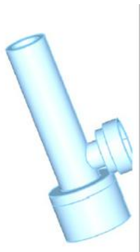
Figura 1. Modelo CAD del resonador de Helmholtz (cavidad cilíndrica con cuello tubular).
