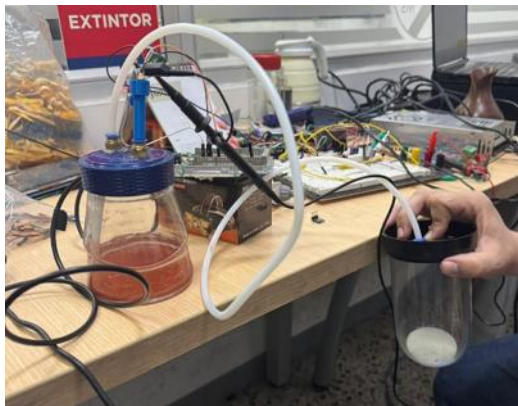
Figura 3. Sistema de generación de \text{CO}_2 mediante la reacción de bicarbonato de sodio con ácido acético conectado al reactor de columna de burbujeo.
