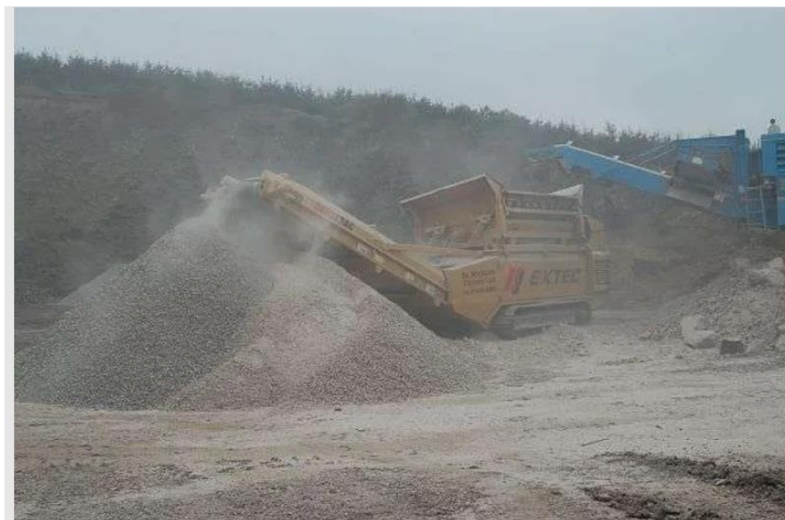
Figura 6. Foto de plataforma Argos_ Trituración de concretos
