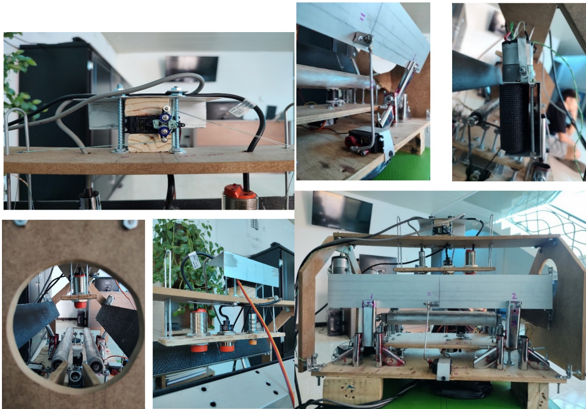
Figure 9: A. Conjunto de Sensores - B. Brazos cúbicos y Sistema de Servomotores
