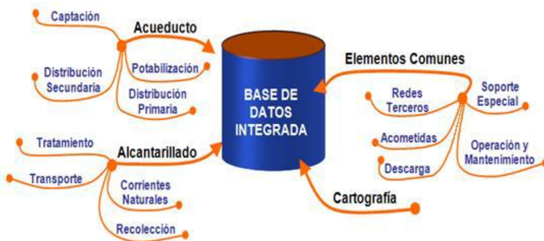
Figura 4 Esquema clasificación grupos modelo digital (Tomado de Instructivo de referenciación EPM)
