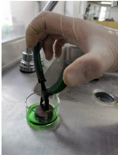
Figura 6. Suspensión de muestra de acero inoxidable 17-4 PH LPBF en reactivo FRY. Fuente: autora.
