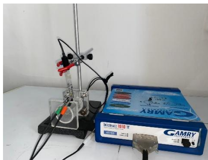
Figura 8. Montaje de la Celda electroquímica para ensayos. Fuente: autora
