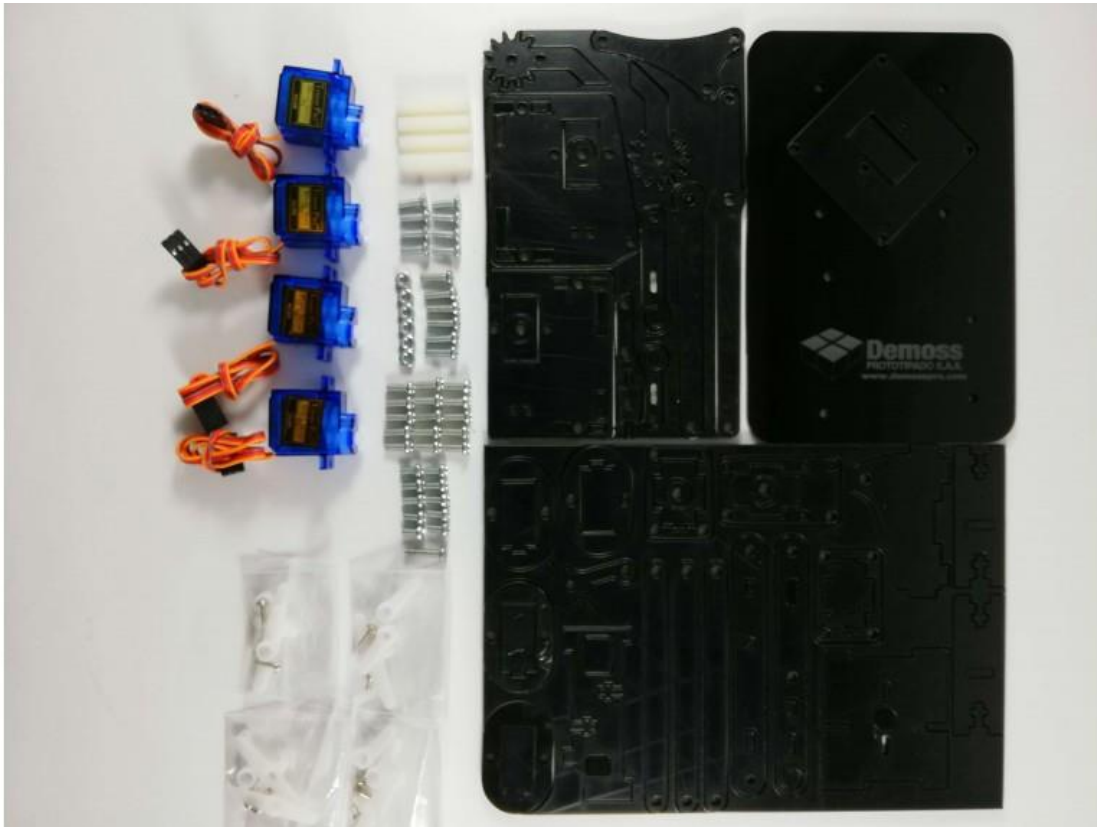
Partes en acrílico del Brazo Robot Robótico Arduino Chasis Incluye Servos Sg90
