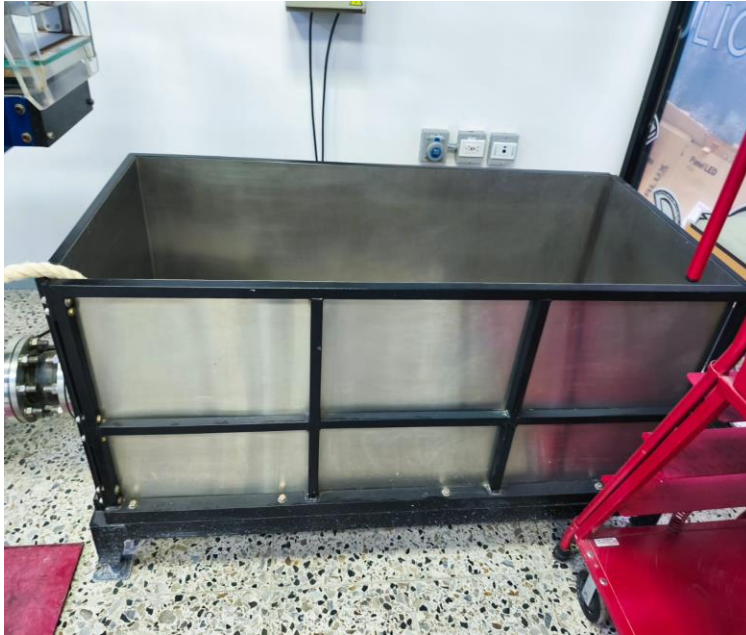
Figura 17 Tanque de descargue de agua del canal.
