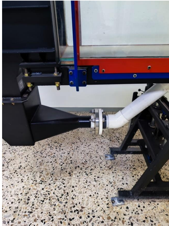
Figura 11 Tubería del canal Hidráulico
