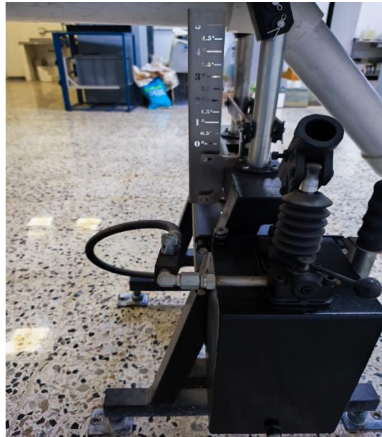
Figura 15 Gato hidráulico de la pendiente del canal de 0^{\circ} a 9^{\circ}
