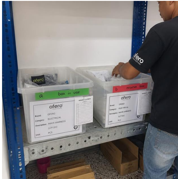
Figura 2. Cajas A en uso y Caja B en reserva con la implementacion del Kanban
