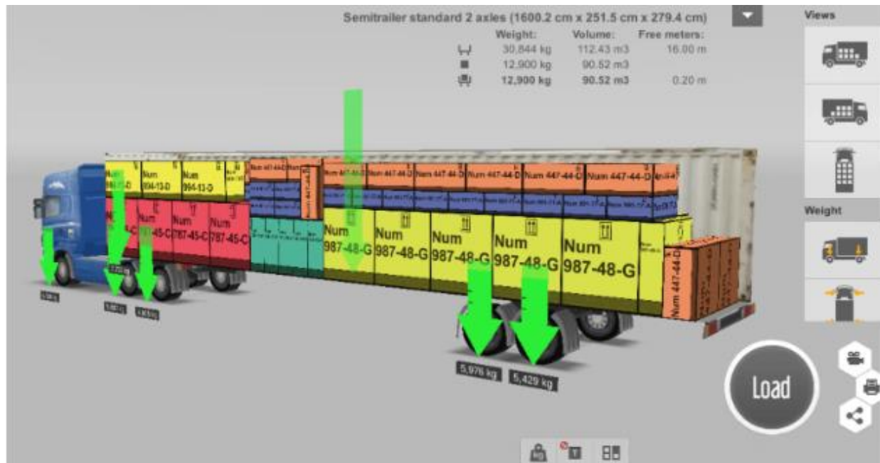
FIGURA 22. Ejemplo del cubicaje con Simuladores de carga
