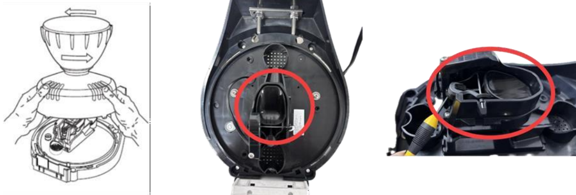
Figura 10. Conectores de los sensores (Fuente: Elaboración propia a partir de los datos de DAVIS (2023))
