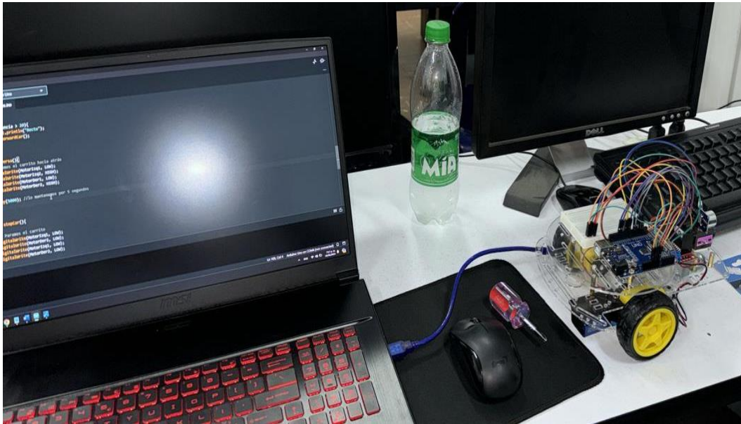
Ilustración 17. Conexión entre el compilador y la Tarjeta Arduino UNO
