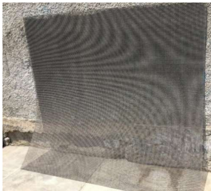
Figure 3, malla que protege las tuberías conectadas a los desagües de elementos extraños.
